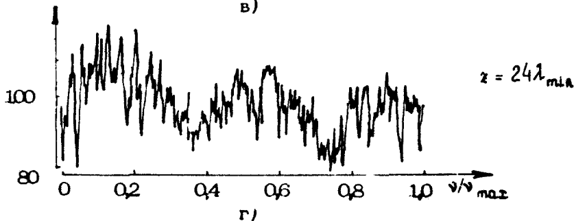
Р и с. 5. Запись амплитуды отклика канала на импульсное воздействие на дистанции 1 км (горизонт источника 4 \lambda_{\min} и горизонт приемника 24 \lambda_{\min} ) (а), спектры сигналов первого донного отражения, принятых на глубинах 8, 16 и 24 \lambda_{\min} (б, в г)
