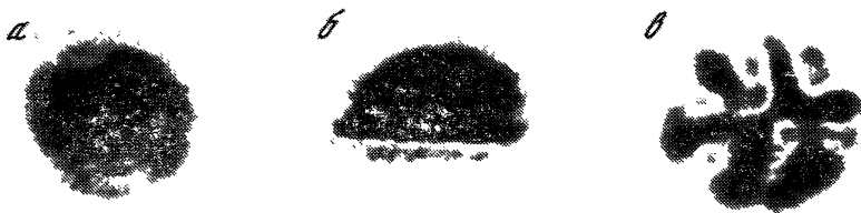
Рис. 6. Пространственная структура светового пучка в контуре обратной связи системы при зеркальном отображении изображения с помощью крышеобразной призмы (см. рис. 4, а)
