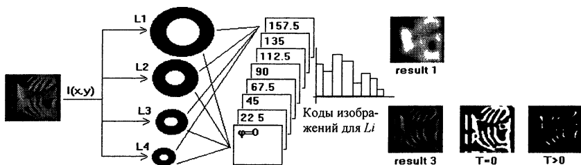
Рис. 7. Пример схемы, используемой для параллельного преобразования входного изображения в наборы требуемых кодовых описаний отдельных фрагментов
