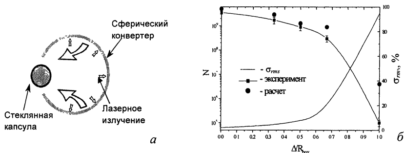
Рис. 5. Схема эксперимента по созданию на поверхности сферически-симметричной капсулы асимметричного рентгеновского поля (а) и зависимость нейтронного выхода и степени неоднородности рентгеновского поля на поверхности капсулы \sigma_{rms} от величины сдвига мишени относительно центра бокса (б)
