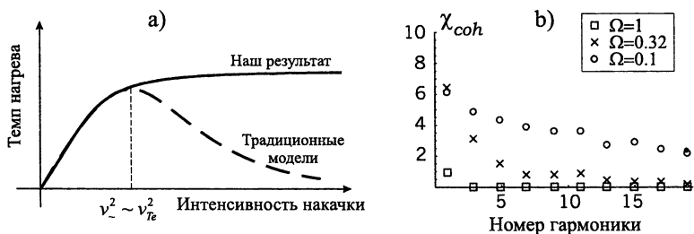
Рис. 7. Качественная зависимость темпа нагрева от интенсивности накачки ( a ); зависимости сечения когерентного излучения \chi_{coh} от номера излучаемой гармоники ( b ) для разных частот поля накачки \Omega .
