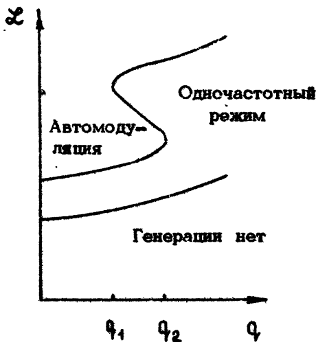
Р и с.8. Схематическое изображение конфигурации областей различных режимов ЛОВ на плоскости; параметр пространственного заряда Q - нормированная длина \zeta
