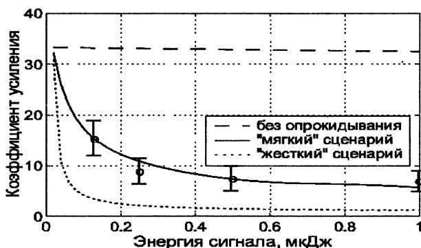
Рис. 3. Зависимость коэффициента усиления от энергии затравочного импульса. Точками нанесены экспериментальные данные, полученные при давлении нейтрального аргона 1 Торр, линиями представлены результаты численных расчетов для разных моделей опрокидывания.
