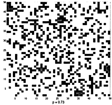
Рис. 2. Задача узлов на квадратной решетке. Концентрация проводящих пикселей p = 0,73 . Серые ячейки квадратной решетки соответствуют проводящим пикселям, изолированным от максимального (белого) кластера.
