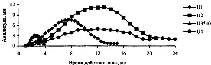
Рис. 5. Изменение амплитуды отскока индентора для различных образцов.
