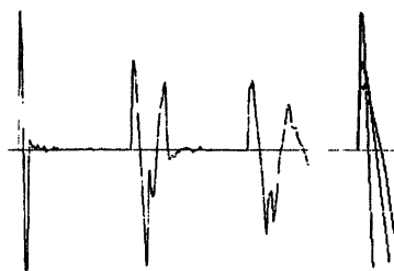
Рис. 2. Пример постоянства крутизны фронта волны для приемников (слева – направо) на 1-м, 20-м и 32-м метрах.
