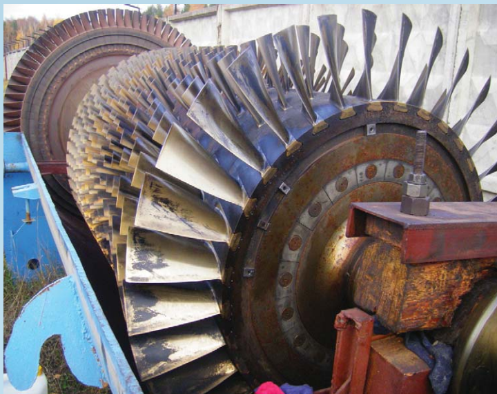
Промышленный газотурбинный двигатель с лопатками, модернизированными специалистами ИПМ РАН методом газоплазменного напыления комбинированных жаростойких и теплозащитных покрытий
