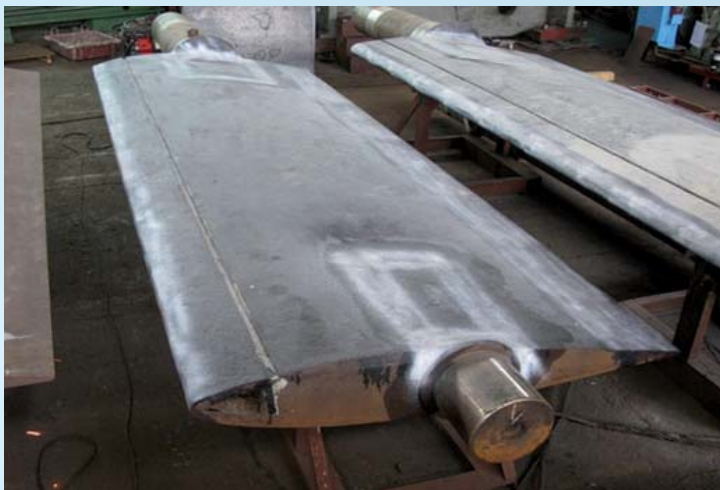
Объект диагностики – лопатки направляющего аппарата гидроагрегата Нижнекамской ГЭС (вес 7 тонн, длина 7 метров, 60 лопаток в агрегате)
