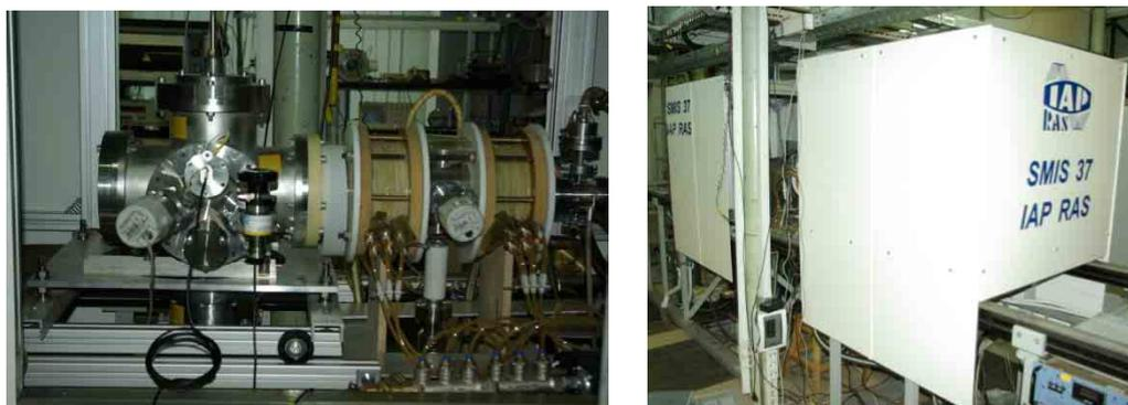
Рис.2. Импульсный прототип нейтронного генератора на основе сильноточного ЭЦР ионного источника SMIS 37.
