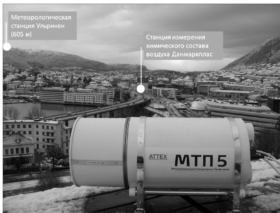
Рис. 1. Профилемер метеорологический температурный производства российской компании “НПО “АТТЕХ” ( www.attex.net ).
