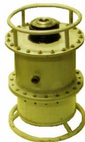
*Широкополосный гидроакустический излучатель (разработан для измерений по методу взаимности)*
