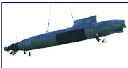
– исследование коэффициентов передачи переменных сил во внешнее поле, частот и форм акустически активных форм колебаний и эффективности примененных средств акустической защиты на масштабной физической модели конструкции, созданной по эскизным чертежам (на левом рисунке);
