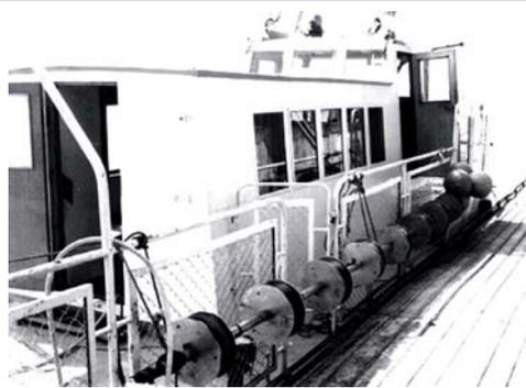
*8-ми элементная излучающая гидроакустическая антенна на борту обеспечивающего судна (на полигоне Горьковского водохранилища)*
