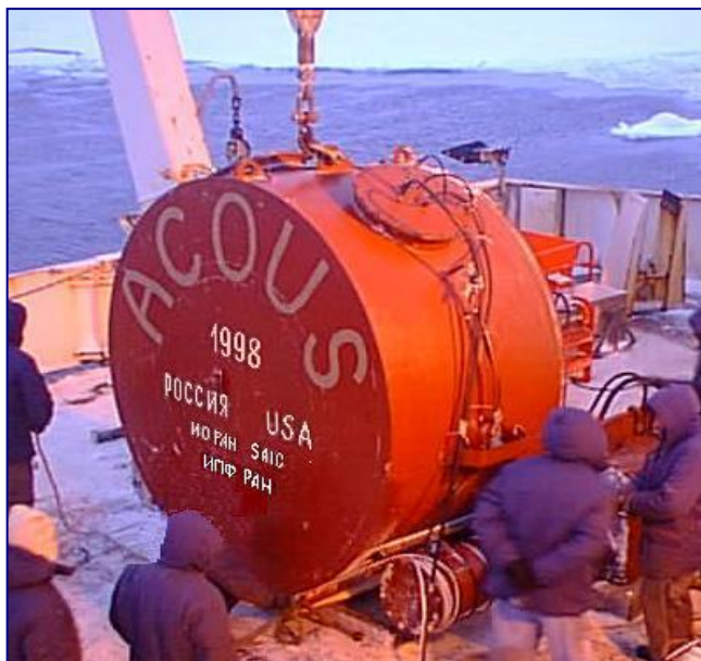
Внешний вид Автономного излучающего комплекса ИГФ РАН на палубе НИС «Академик Федоров» перед установкой (слева), контейнер с силовой электроникой и коммутационная панель (справа сверху) и контейнер с электроникой управления (справа внизу), установленные внутри Комплекса
