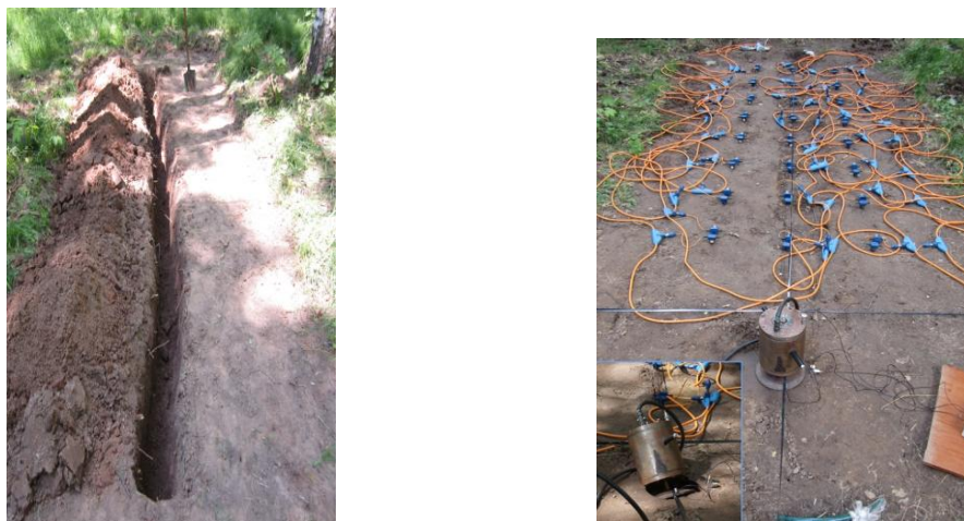
Рис. 29. Слева: раскопанная заранее траншея. Справа: фотография с места проведения эксперимента. На вставке показано положение вибратора после потери устойчивости грунта.
